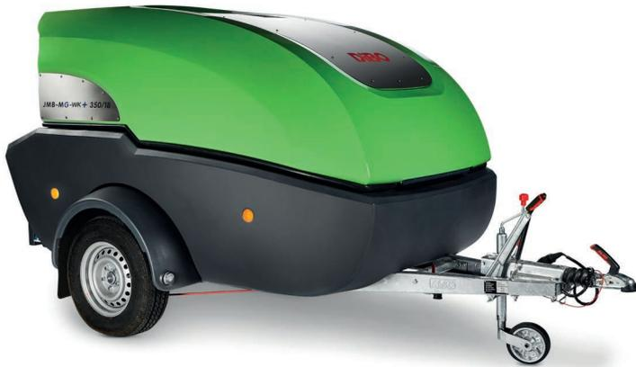
Ökologische Wildkrautbekämpfung und grünes Reinigen mit dem neuen DiBO Hochdruckanhänger **JMB-MG-WK**. Der DiBO **JMB-MG-WK** ist ein Anhänger, der vollständig **mit CNG-Gas betrieben** wird.
