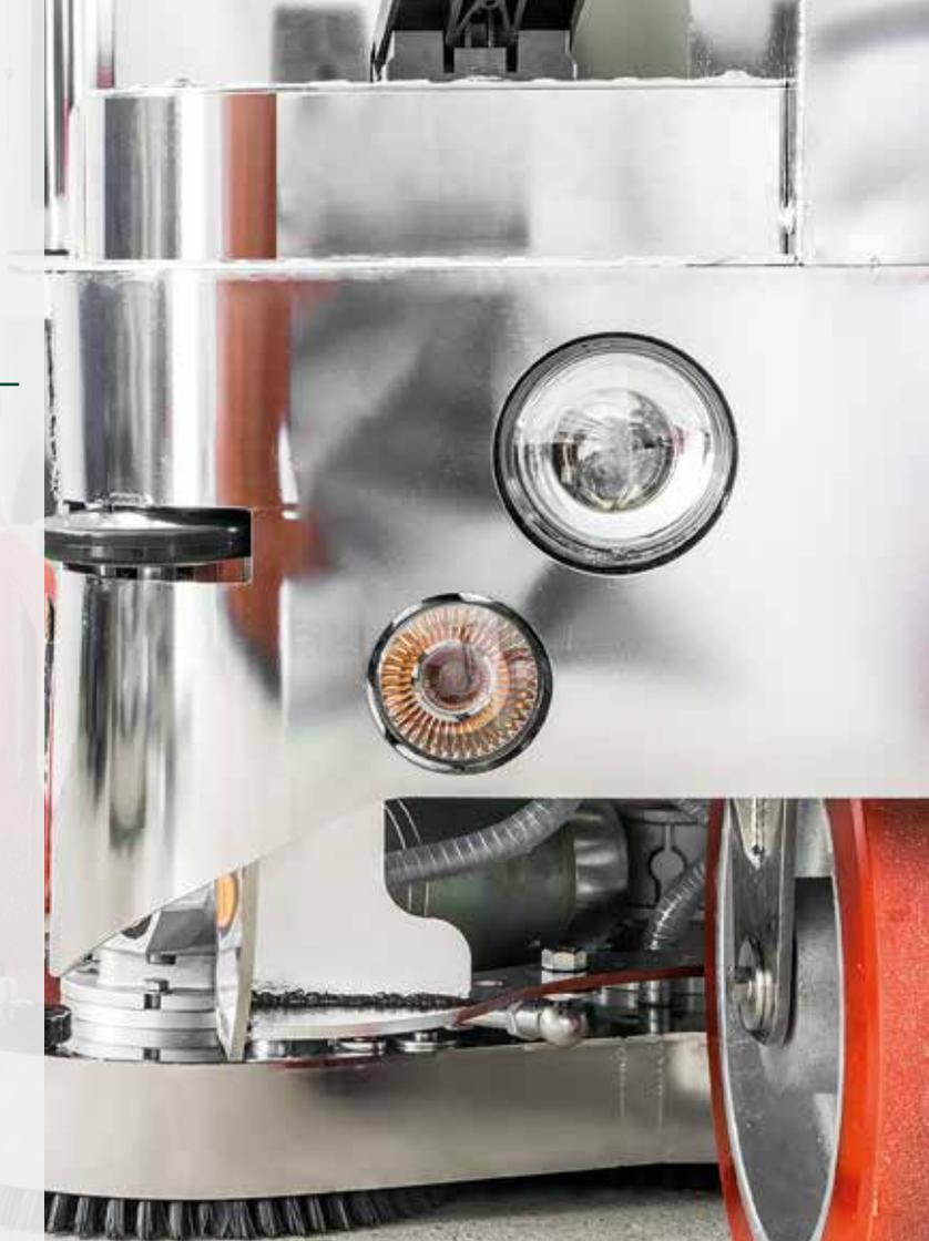
**Ein direkter Blick auf den Bürstenkopf während der Reinigungsfahrt ermöglicht randdirektes Arbeiten mit erheblich verringertem Schadensrisiko.**
