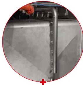
**Abblasdüsen für IBC-Container-Außentrocknung**
