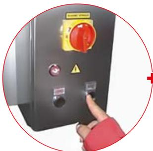
**NIEROS® Hold & Work**-Prinzip wird durch eine Einheit definiert, die nur so lange funktioniert, wie der Bediener den Aufzug oder die Abfahrtstaste hält. Im Falle eines Unfalls stoppt das Gerät sofort den Betrieb.
