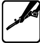
Das Sprührohr ist während des Betriebs einer Schubkraft ausgesetzt. Halten Sie es daher immer fest mit beiden Händen. **WICHTIG: Halten Sie die Düse so, dass sie zum Boden weist.**
