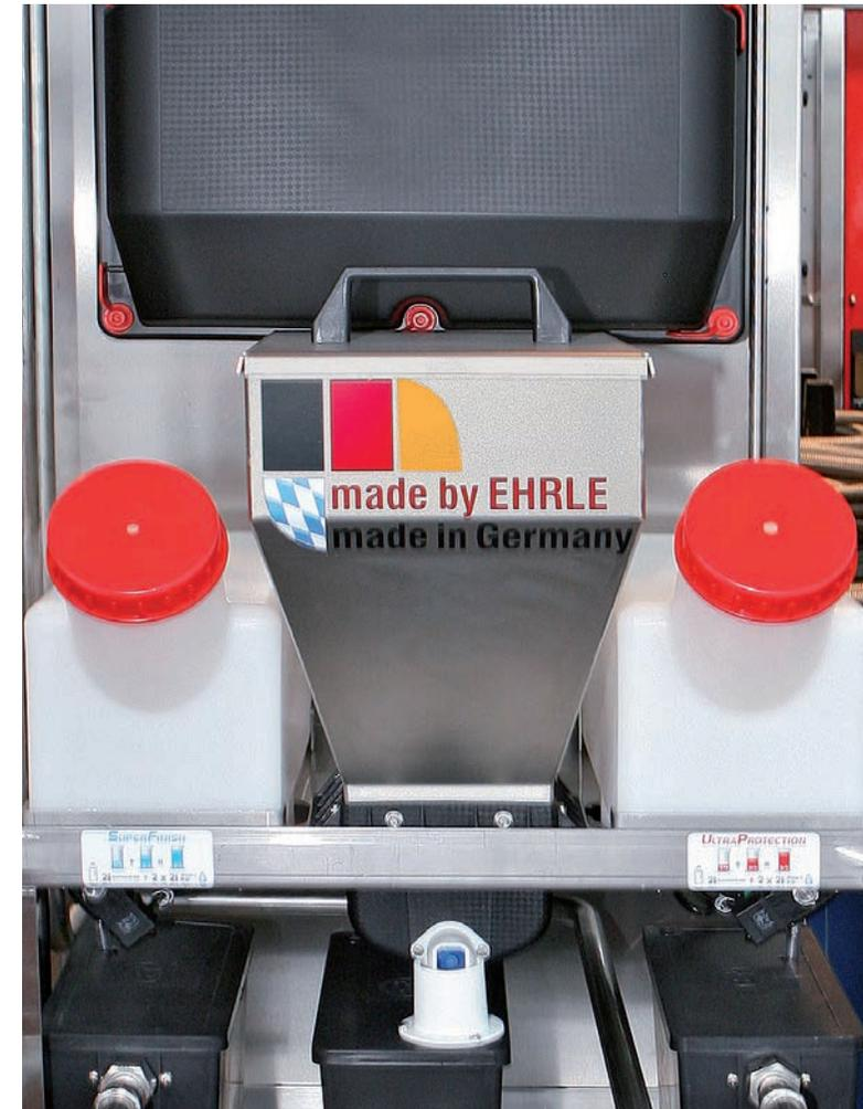
Chemiedosierebene mit MicroPulver Dosierung und Flüssigchemiedosierung
